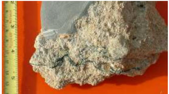
Detalle de la forma de inclusión del microcemento (en verde oscuro) en el material aluvial. En la parte superior izquierda de la foto (en gris) parte de una lengua de la fase de "claquage" con cemento convencional. Escala en cm y pulgadas.
