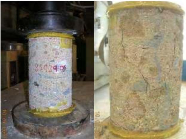
Probeta tallada en laboratorio a partir de muestra en bloque del aluvial inyectado, antes y después de rotura (enero 2007).
