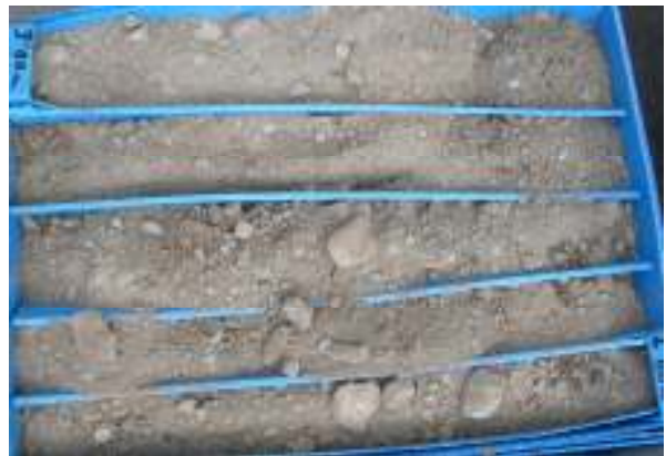
Aspecto del material aluvial formado por arenas de finas a gruesas con algunos finos y gravas, objeto del tratamiento.
