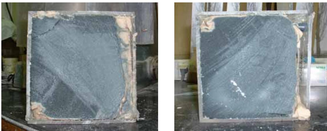
Figura 9.- Ensayo patrón. Detalle de los fragmentos izquierdo y central de la probeta de la figura 8, respectivamente.
