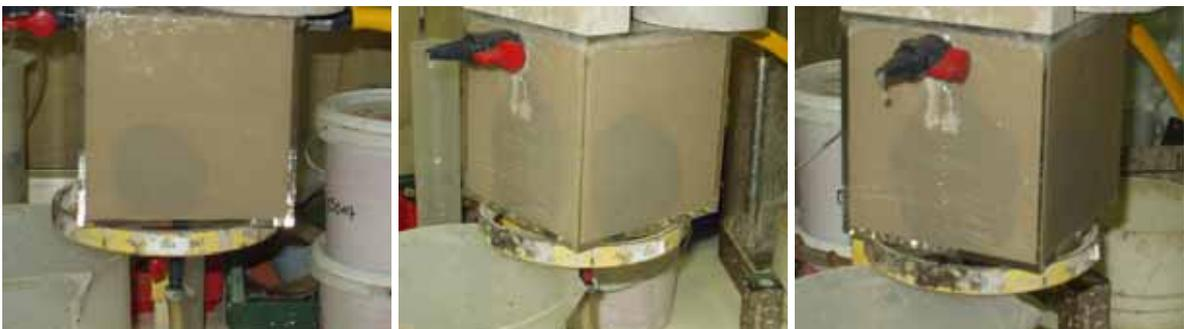
Figura 6.- Ensayo patrón. Inicio de inyección de la lechada de microcemento manteniendo la circulación de agua.
