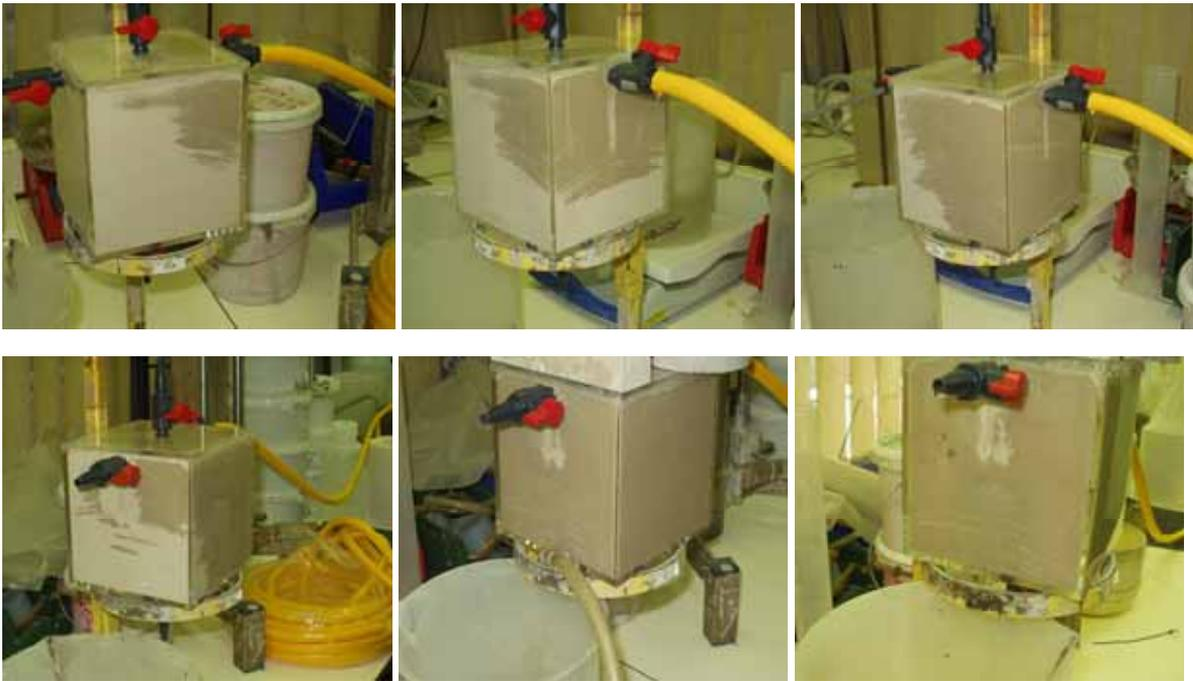
Figura 5.- Proceso de saturación de la probeta cúbica de arena normalizada en el ensayo patrón.
