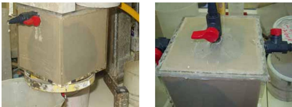
Figura 7.- Ensayo patrón. Progresión y fin de inyección de la lechada de microcemento, respectivamente.
