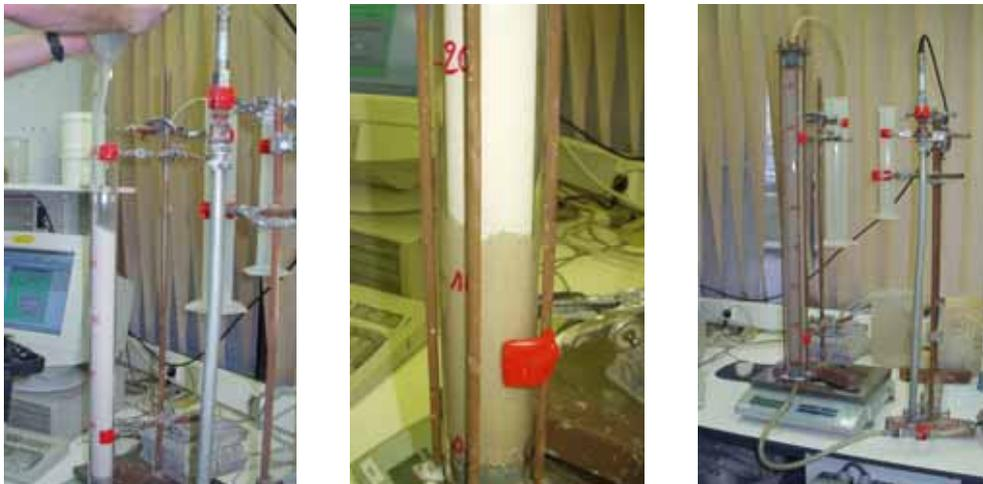
Figura 3.- Ensayo de inyección de columna de arena normalizada por Holcim para el Spinor A12.
