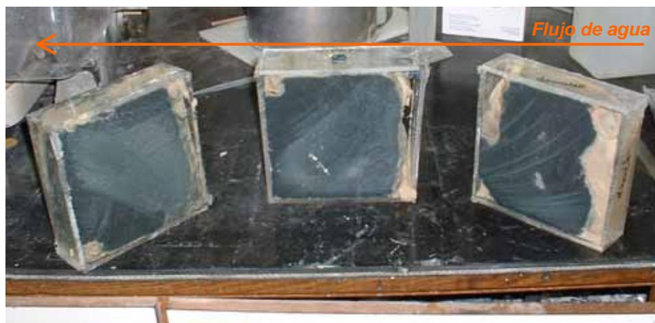
Figura 8.- Ensayo patrón. Tallado de la probeta a los 28 días.
