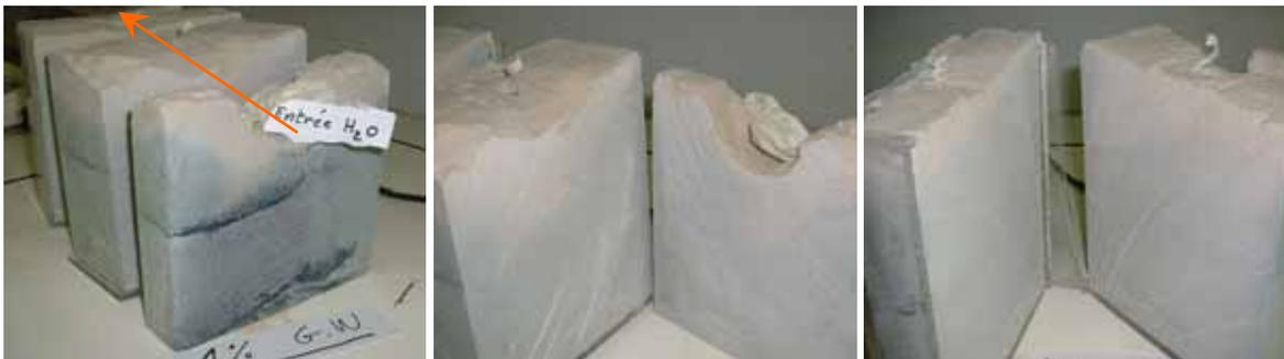
Figura 14.- Ensayo con circulación de agua y un 0,1 % de agente gelificador GW.
