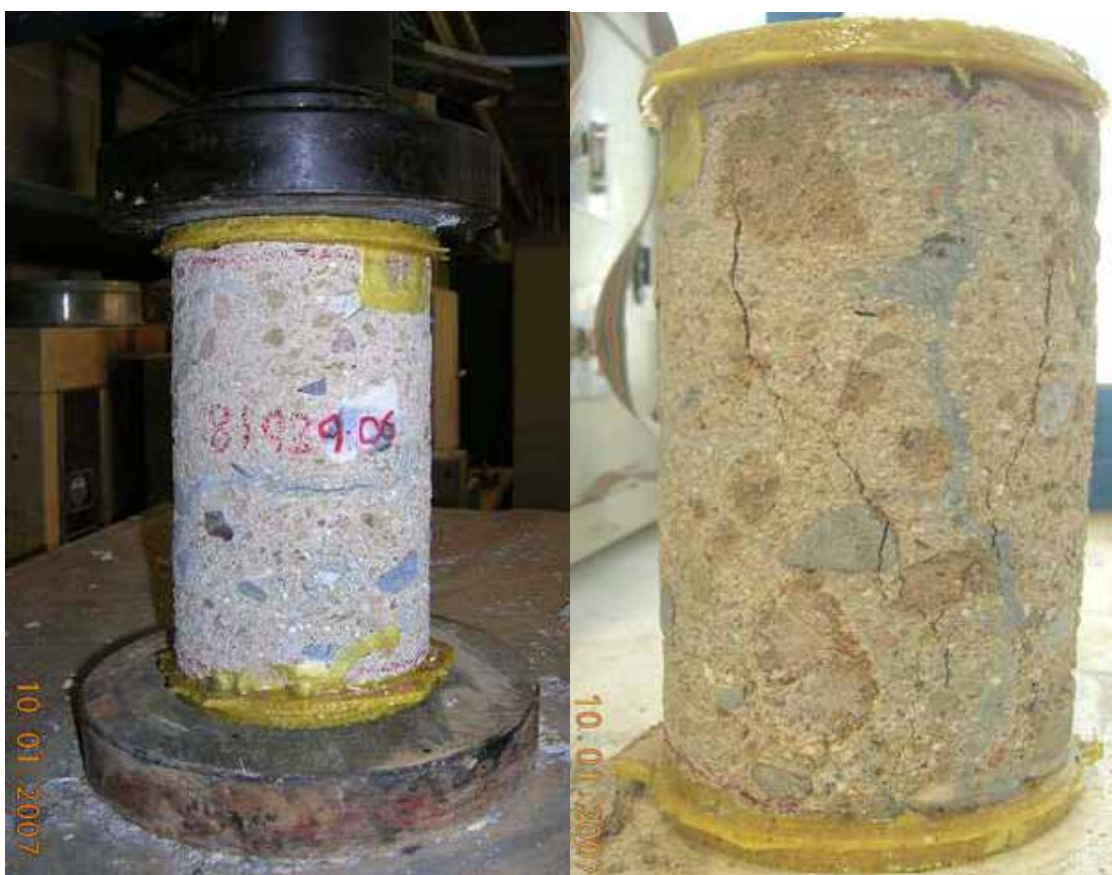
[Figura 12] Probeta obtenida a partir de la muestra en bloque, antes y después de ensayada.
