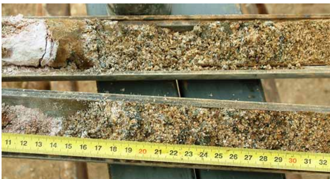
[Figura 11] Detalle de la forma de inclusión del microcimento en el aluvial.
