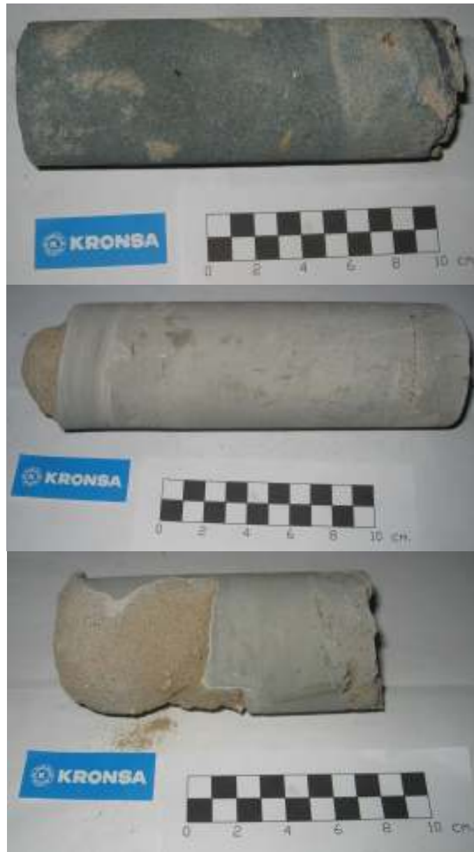
[Figura 7] Testigos de arenas impregnadas con microcemento Spinor A12.
