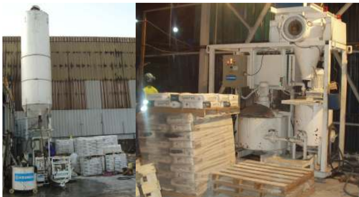
[Figura 5] Vista del silo de cemento de 45 t con palets de microcemento Spinor A12 al lado (imagen de la izquierda) y mezcladora de alta turbulencia AC-83 Domine con palets de microcemento delante (imagen derecha).
